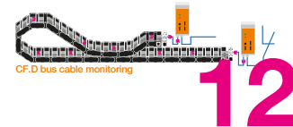
Sensor for measuring the transmission quality of Ethernet bus cables (CF.D) Sensor zur Messung der Übertragungsqualität von Ethernet-Busleitungen (CF.D)
